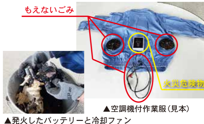
▲発火したバッテリーと冷却ファン
